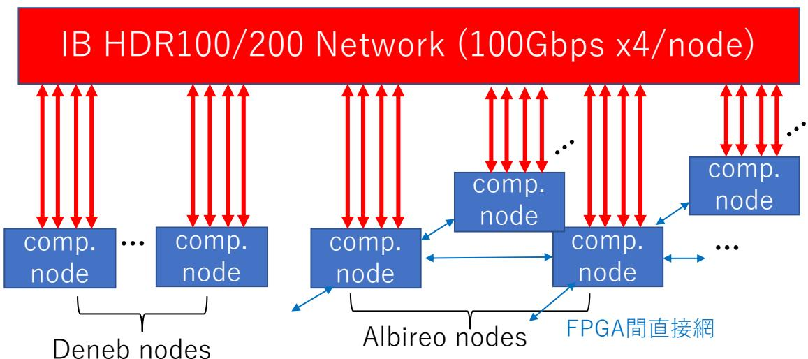
全ノード共通の並列処理ネットワークはInfiniBandによる通常のネットワークで、MPI等による並列処理が可能。CPU及びGPUの通信に用いるが、FPGAからCPUを介しての通信も可能。
