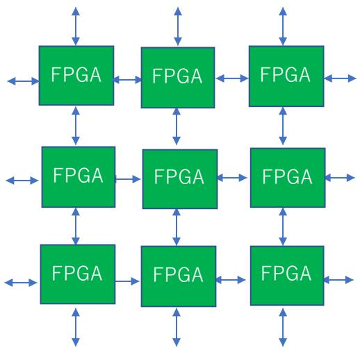
Albireoノードの64台のFPGA (2 FPGA/node) は2次元トーラスネットワークによりスイッチなしで結合される
