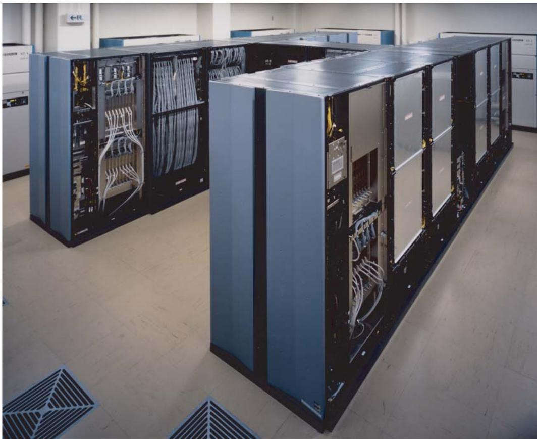
写真2 超並列計算機 CP-PACS (2048PU)
